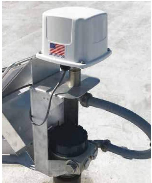
La medición se realiza con sensores electrónicos colocados a iguales distancias entre sí dentro de una sonda rígida (para pequeños tanques) o flexible de acero inoxidable recubierta en plástico (PE antiestático) en su versión para sólidos o sin recubrimiento en su versión para líquidos.
